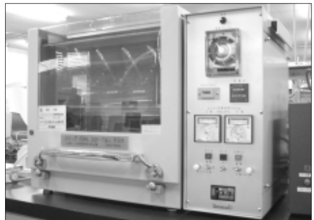
写真1 スイングパネル試験機
