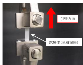
塗膜引張試験の様子
