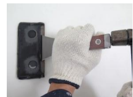
剥離距離(ハツリ試験)
