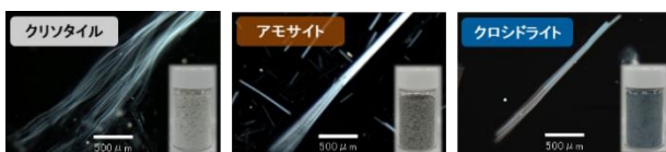
図1 アスベストの外観
