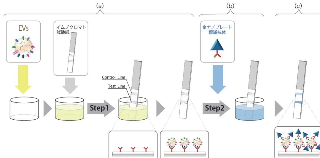
(a) EVsを含む検体をイムノクロマト試験紙に展開すると、イムノクロマト試験紙のTest Line上に固定化された抗体によってEVsが捕捉される。
