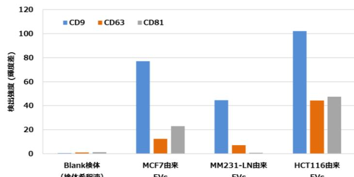
検出強度はTest Line(試験紙下側のライン)の色の濃さを画像解析で数値化
