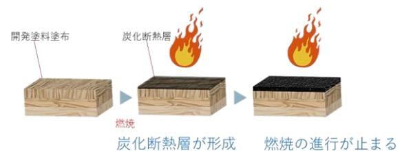
図5 防火性能発現のメカニズム
