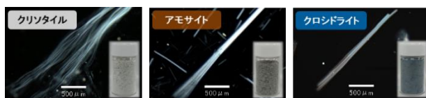
図1 アスベストの外観
