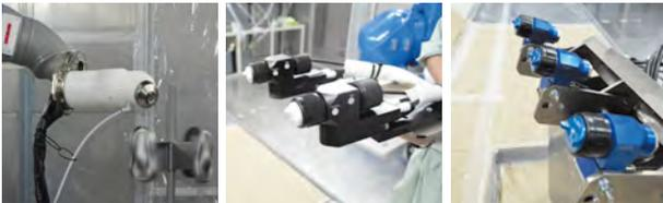
塗装環境(温度、湿度コントロール)による塗装作業性や被塗物形状による最適な塗装ガン(ロボベル・静電ガン・エアガン)選定の検証を行うことができます。さらに、フローコンベアに回転機能を設置しているため、各種塗装機の選択によるライン条件の高い再現性により、実機レベルでのスピンドル塗装の検証も可能です。
