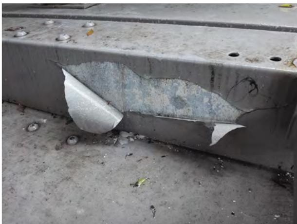
図1 溶融亜鉛めっきにおける塗膜はく離事例
