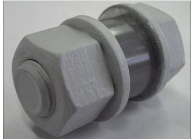
図7 塗装試験体
