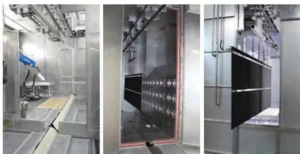
塗装設備は、液体ロボット塗装エリア、粉体自動塗装エリアおよび乾燥炉がコンベアで連結されており、さらに同一フロアーに、インクジェットプリンター、インモールドコーティング装置があるため、
