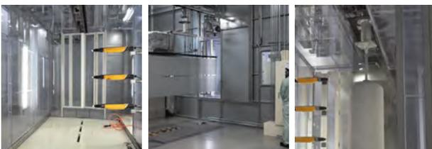
最大横3m×高さ1.5mまで塗装可能なため、実ワークでの塗装が可能です。実際の工場ラインに近い塗装条件での検証が可能のため、箱ものなどのガン距離の異なる部位への塗着性・仕上がりが外観の確認が可能です。さらに、自転しながら塗装が可能のため、ポンベ、消火器などの立体物にも塗装可能です。
