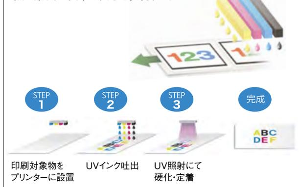
パソコン上(デザインソフトなど)で様々な意匠を検討することができ、UV硬化形インクジェットと塗料の複合塗膜による高意匠化の検証を行うことができます。さらに、加飾部は凹凸表現も可能なため、シボ調・ヘアラインなど質感・触感(手触り感)といった提案もできます。
