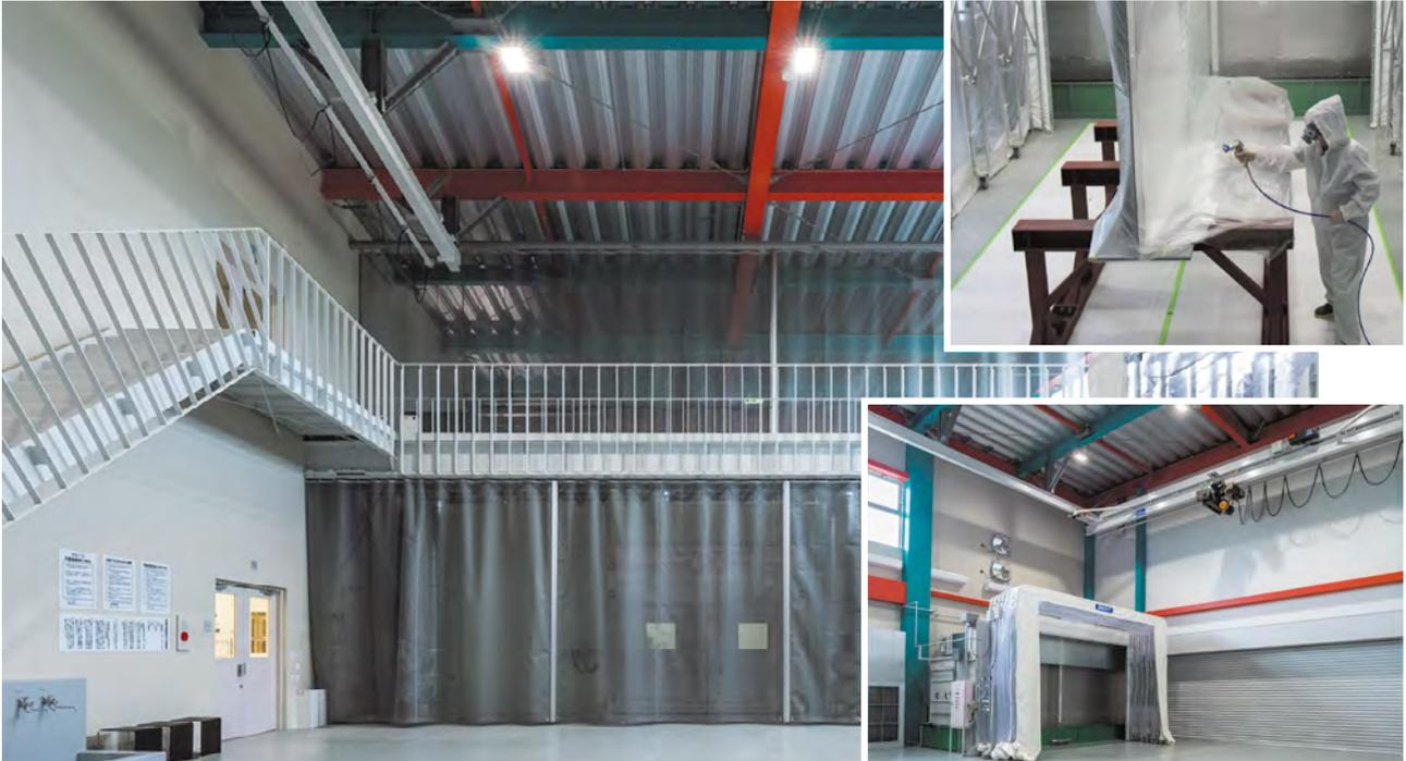
実際の大型構造物を模擬した構造体を用いた塗装試験を行うことができます。また、大型塗装ブースも設置しており、エアレススプレーなどを用いた試験も可能です。
