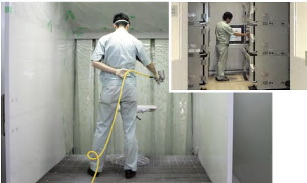
温度および湿度が制御された環境下での試験片の作製を行うことができます。温湿度試験室では最大12水準の温湿度条件における塗膜の乾燥性を同時に確認できます。
