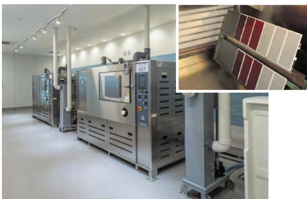
ISO12944-9付属書Bに準拠したサイクル劣化試験を実施可能である複合サイクル試験機を設置しています。
