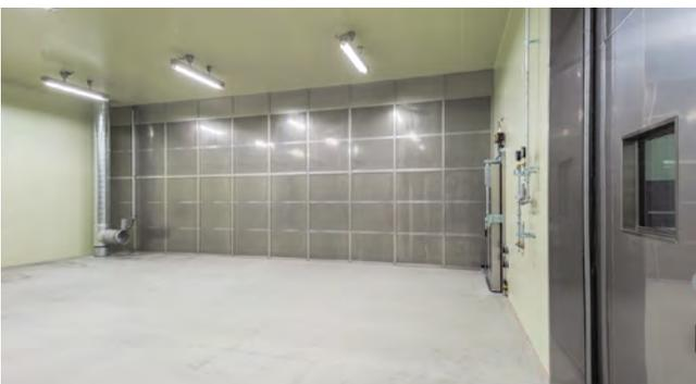
温度や湿度をコントロールできるため、様々な温湿度環境下で大型の模擬構造物を用いた塗装試験を行うことができます。
