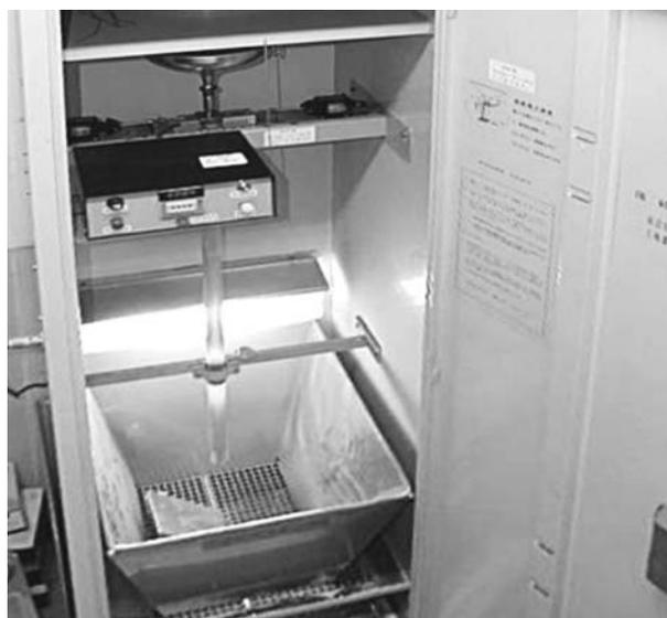
図3 落砂摩耗試験機
