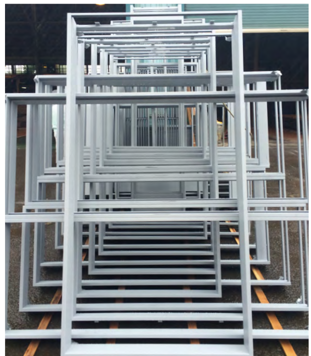
図6 鋼製建具(サッシ枠)
