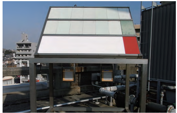
写真3 中国技術事務所屋上暴露試験
