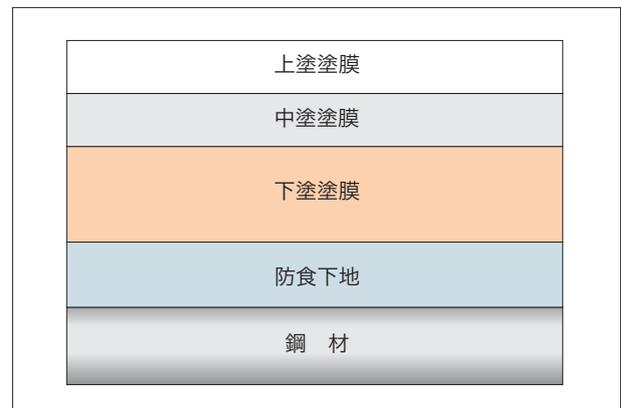
図1 重防食塗装系の塗膜構成
