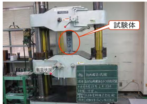
※すべり性試験には、鋼材：SM490A/グリッドプラスト鋼板、ボルト：M22/S10Tを使用
