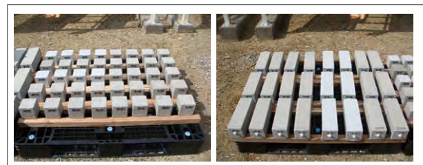
図4 暴露場所と設置状況
