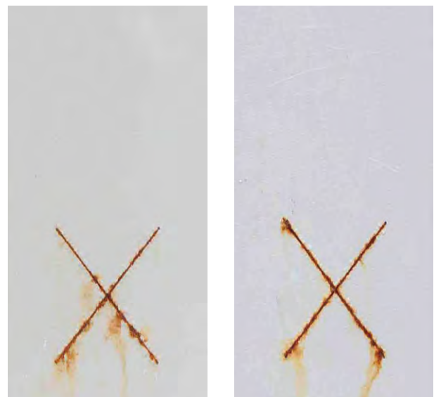
図2 サイクル腐食性試験結果(左:溶剤形 右:水性)
