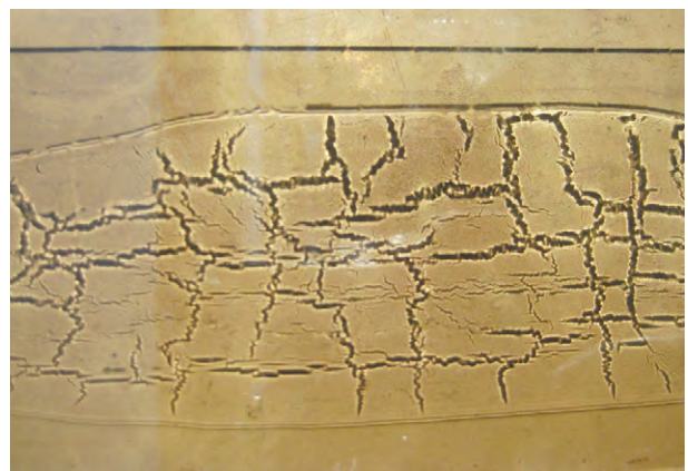
図6 ガラス板上でチェックした塗膜
