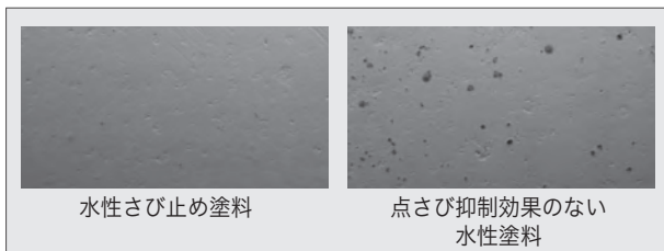
図1 点さびの発生状態
