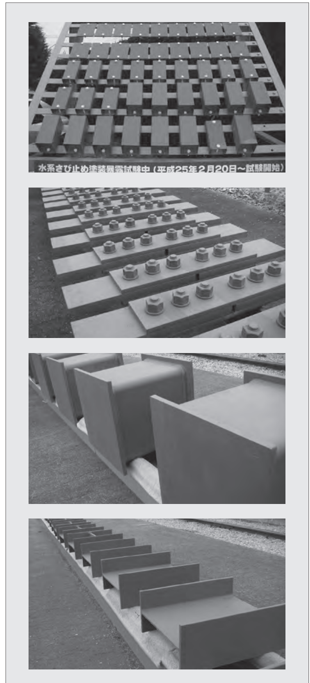
図4 様々な部材形状での水性さび止め塗料屋外暴露試験
