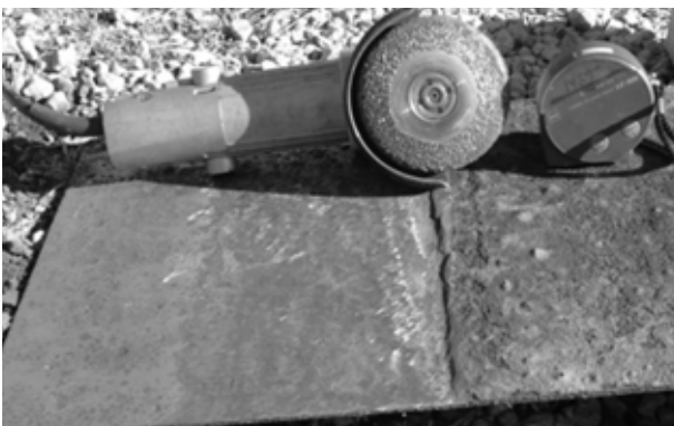
写真2 開発工具と層状の固着さびの除去試験結果
