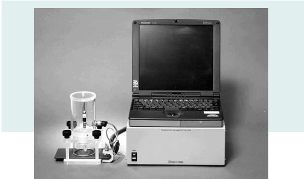
図4 塗膜下金属腐食診断装置 HL201
