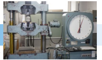
垂直引張付着力（円柱式）試験状況 ▶
