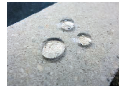
セパリートコート塗布後の コンクリート表面の撥水状況
