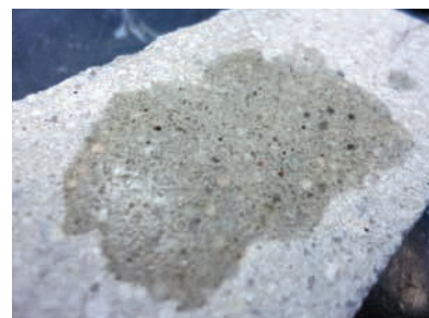
セパリートコート塗布前の コンクリート表面の親水状況
