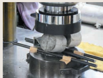
割裂試験状況
