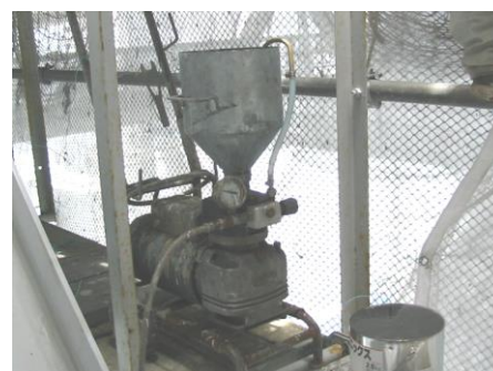
ホッパー型電動エアレスで塗料を圧送(1000 \mu mタイプ超厚膜形エポキシ樹脂塗料適用時)
