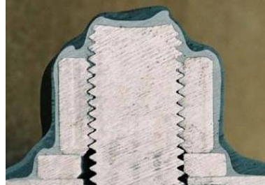
カップ塗装後のナット部 断面写真 (塗料付き廻り状態の確認写真)
