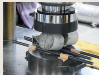
割裂試験状況
