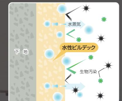
基材内部の水分を水蒸気の形で外部へ放散する呼吸形皮膜を形成、膨れやはがれを防止します。
