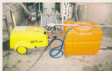
高圧洗浄装置
