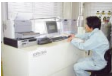
ICP(誘導結合プラズマ)発光分析装置
