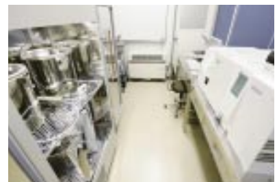
小型チャンバー法VOC測定装置
