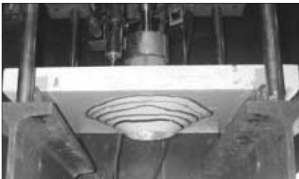
図5 50 における押抜荷重試験状況
