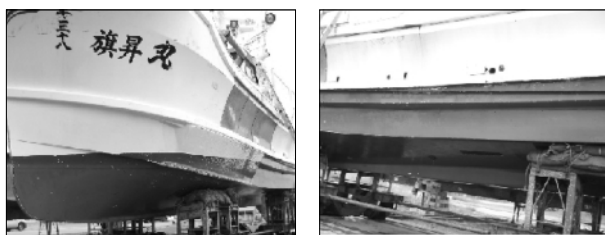
図7 漁船での試験結果 (DNT品、運航6ヶ月間)
