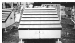
写真4 暴露試験台
