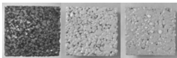
写真4 アスファルト舗装材塗装試験における浸透水量
