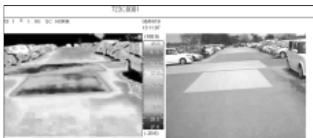
写真2 駐車場塗装試験における熱画像撮影での表面温度測定
