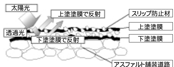
図5 遮熱舗装用塗料の反射機構
