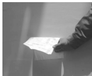
写真2 貼り紙除去性の確認状況 ( 水糊で貼り付けた貼り紙が容 易に除去できる )
