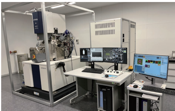
図1 FIB-SEM複合装置(ETHOS NX5000)外観 本報では、高性能FIB-SEM複合装置と、その活用事例について紹介します。
