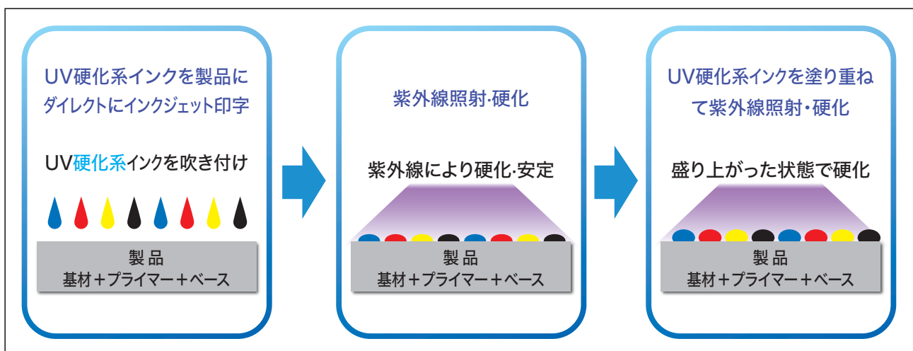
図2 UV硬化系インクの塗膜形成
