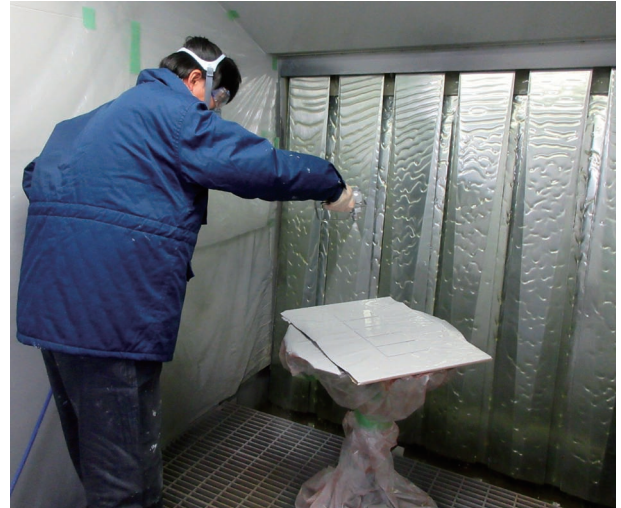
図3 恒温恒湿塗装ブースTP作製
