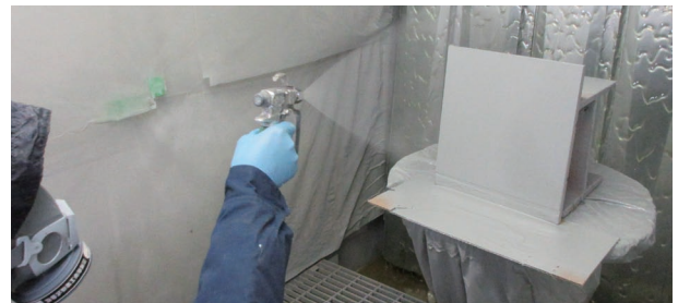
図4 「タイエンダー下塗」の-5°C塗装作業性確認の様子
