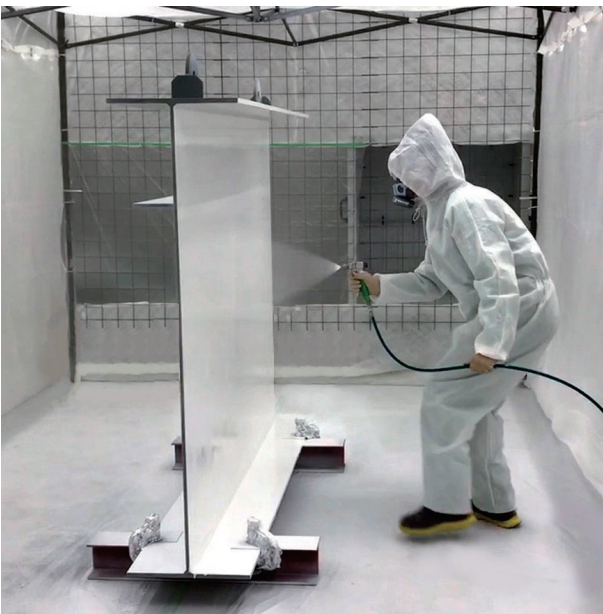
図6 大型環境試験室エアレス塗装作業性
