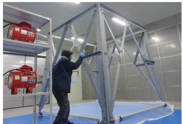
図7 大型環境試験室はけ塗り飛散性
