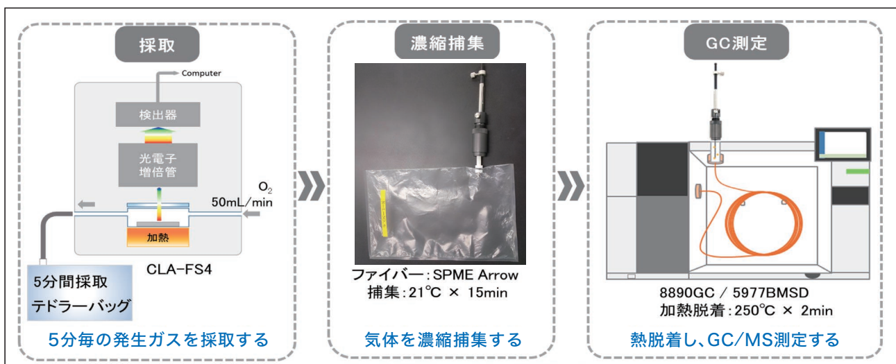
図3 昇温過程における発生ガス測定方法
