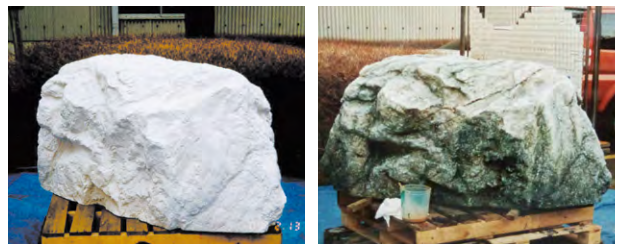
図8 擬岩塗装 (左: 塗装前、右: 塗装後)
