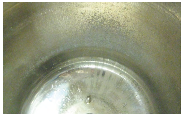
図3 反応釜壁面に付着した凝集物
