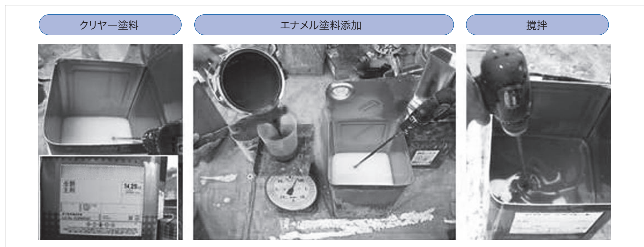
図10 カラークリヤー塗料の調合方法
