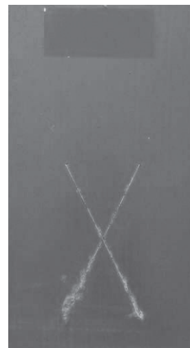
サイクル腐食性試験結果 (200サイクル)
