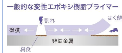
経年で塗膜の伸縮が繰り返された結果、塗膜の割れや剥離が発生する。
