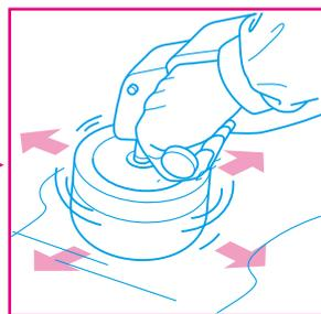
塗膜面にコンパウンドを付け、指定バフにてポリッシャーを始動させる。
