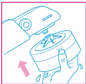
バフとパッドのセンターが正確に合うように取り付ける。
