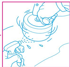
バフに水分が少なくなったら、霧吹きスプレーにて水を補給する。(ボディ面かバフ面に)
