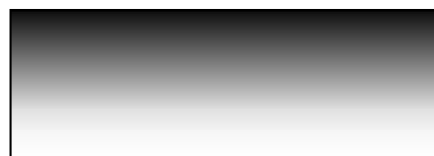
図-3 開発品の塗膜断面模式図 (膜内でSi濃度の傾斜構造を形成)
