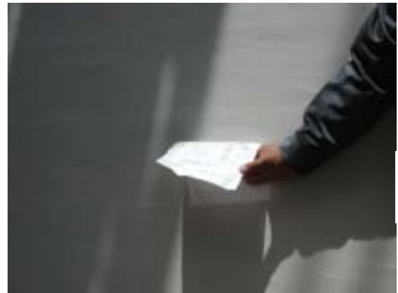
写真-5 貼り紙除去性の確認状況 (水糊で貼り付けた貼り紙が容易に除去できる)
