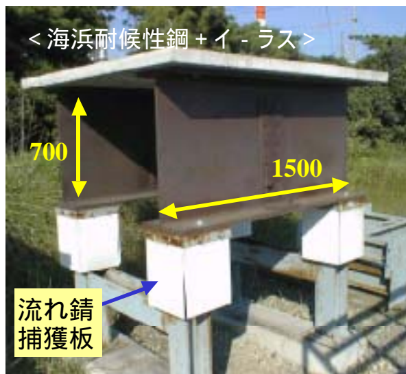
模擬構造体の外観(設置1年後)
