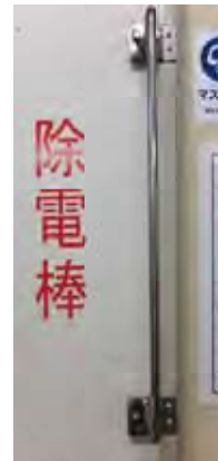
除電棒の設置
