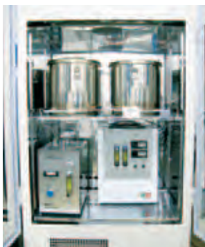
小型チャンバー法 VOC測定装置
