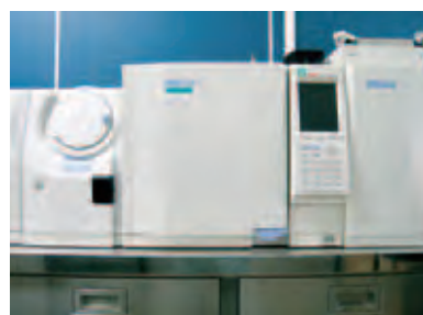
小型チャンバー法 VOC測定装置
