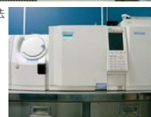
小型チャンバー法 VOC測定装置
