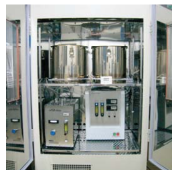
小型チャンバー法 VOC測定装置
